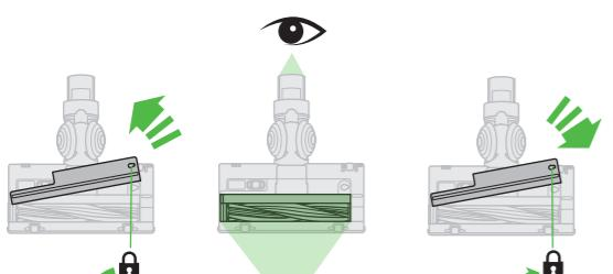
クリーナーヘッドにゴミが詰まつた場合、コインを使用して鍵のマークの付いたネジを緩め、ソールプレートを取り外してください。
