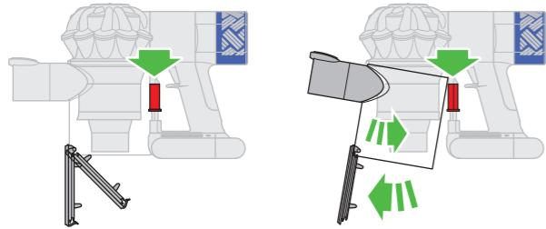
本体を冷ましてから、クリアビンの横にある赤いボタンを押します。一度押すとピンの底が開きます。もう一度押すと、製品本体からクリアビンを取り外せます。
