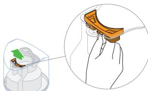
タンクをひっくり返し、パッキンを取り外します。タンク下部から手を入れ、固定タブをつまんだまま、パッキンをタンク上部から引っ張ります。推奨されているクエン酸溶液に15分浸けて、しっかりと洗浄します。十分に水道水ですすぎ、表面全体を拭きます。必要な場合は繰り返し行います。再度取り付ける場合は、カチッと音がするまでタブを押し、固定します。
