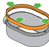
円形パーツを元に戻す際は、円形パーツを本体に対して水平にし、位置を合わせます。図に示すように定位位置でカチッと音がするまでしっかりと押します。
