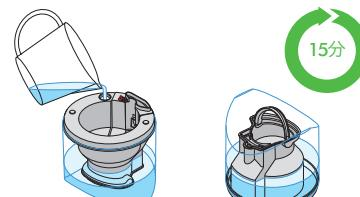
タンクを空にし、（お手入れ方法のページで推奨されている）クエン酸溶液を入れます。給水キャップを閉め、タンクを30秒振った後、15分置いておきます。
