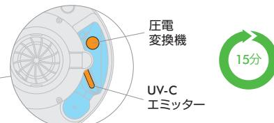
たり、食器洗浄機に入れたりしないでください。トレイのUV-Cエミッターと圧電変換機が浸かるまで推奨されているクエン酸溶液を満たします。15分放置します。排水して十分に水道水で洗い流し、表面全体を拭きます。
