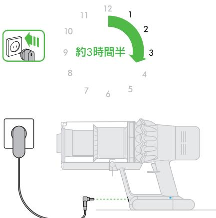
収納用プラケットを使用するか、バッテリー充電器に直接接続します。
