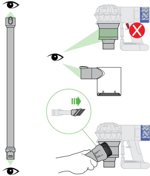
クリアビンの底が閉まっていること、またクリアビンが装着されたことを確認し、掃除機を使用してください。カチッ
