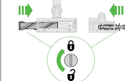
用途に合わせてクリーナーヘッドや付属ツールをパイプの先に装着します。
