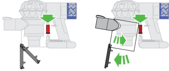
本体を冷ましてから、クリアビンの横にある赤いボタンを押します。1度押すとビンの底が開きます。もう1度押すと、製品本体からクリアビンが取り外せます。
