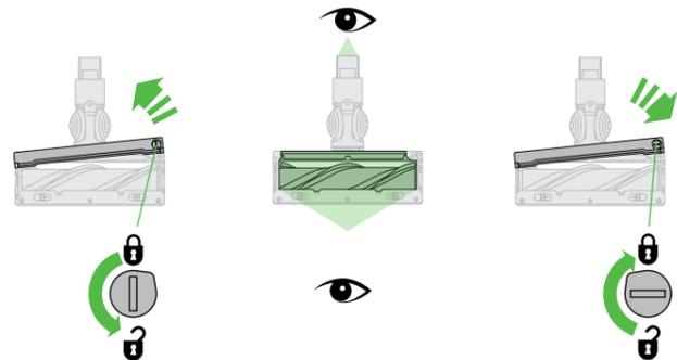
クリーナーヘッドにゴミが詰まった場合、コインを使用して鍵のマークの付いたネジを緩め、ソールプレートを取り外してください。異物を取り除いたらソールプレートに戻し、再度ネジを回して固定してください。
