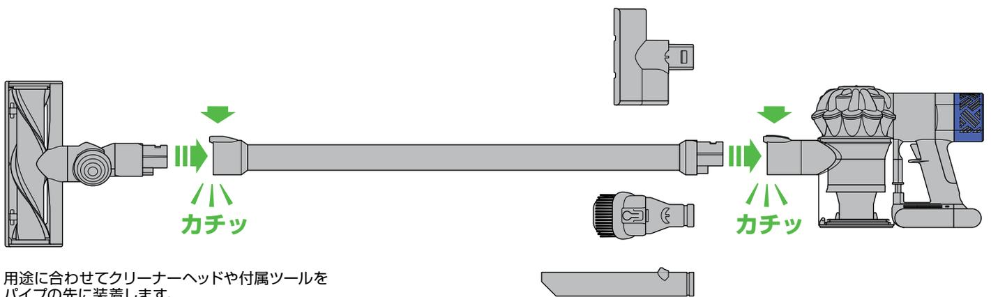
用途に合わせてクリーナーヘッドや付属ツールをパイプの先に装着します。
