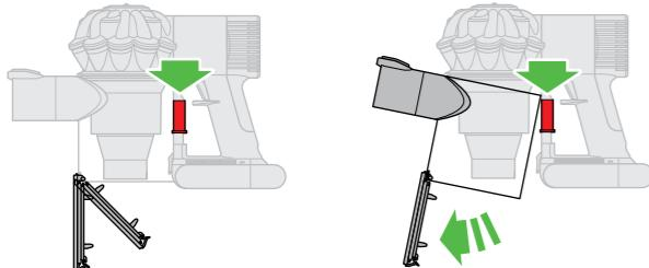
本体を冷ましてから、クリアピンの横にある赤いボタンを押します。一度押すとピンの底が開きます。もう一度押すと、製品本体からクリアピンが取り外せます。
