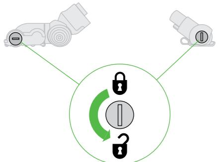
用途に合わせてクリーナー・ヘッドをパイプの先に装着します。
