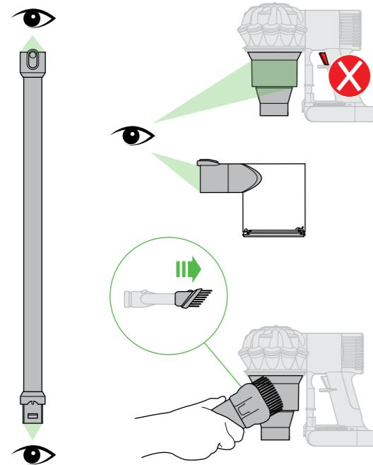
クリアピンの底が閉まっていること、またクリアピンが装着されたことを確認し、掃除機を使用してください。
