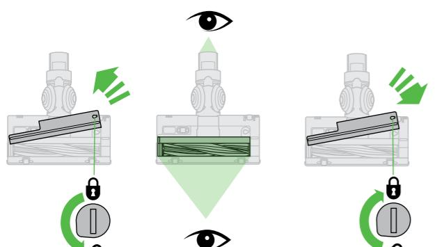
クリーナーヘッドにゴミが詰まつた場合、コインを使用して鍵のマークの付いたネジを緩め、ソールプレートを取り外してください。
