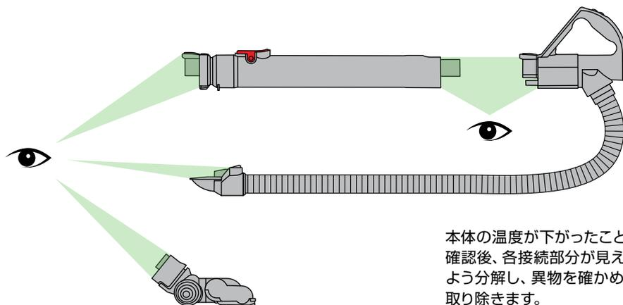
本体の温度が下がったことを確認後、各接続部分が見えるよう分解し、異物を確認取り除きます。
