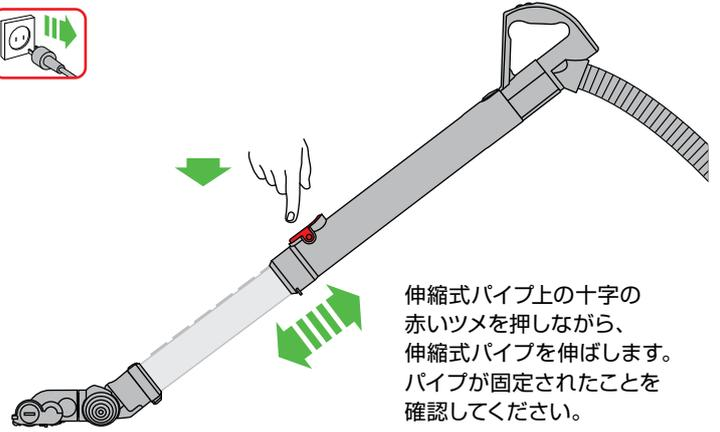
伸縮式パイプ上の十字の赤いツメを押しながら、伸縮式パイプを伸ばします。パイプが固定されたことを確認してください。
