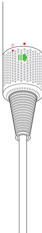
フィルターカバーを本体にスライドさせて戻し、時計回りに回します。
