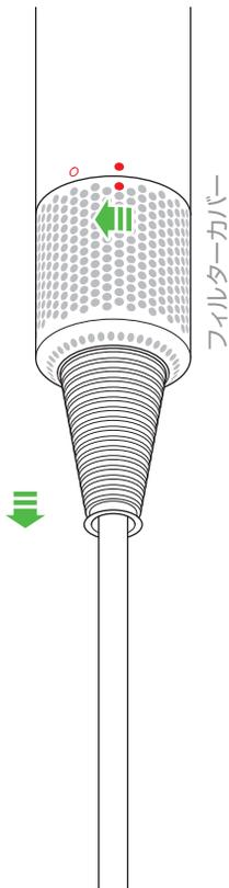
製品のハンドルをしっかりと握り、フィルターカバーを反時計回りに回します。
