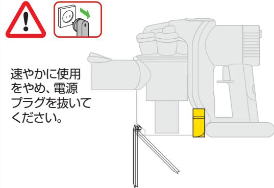
本体が冷えた後、クリア bin 底面の赤いボタンを押し、クリア bin を取り外します。
