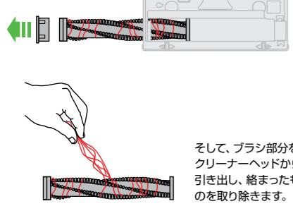
ブラシを戻し、必ず溝をロックし、再度固定してください。
