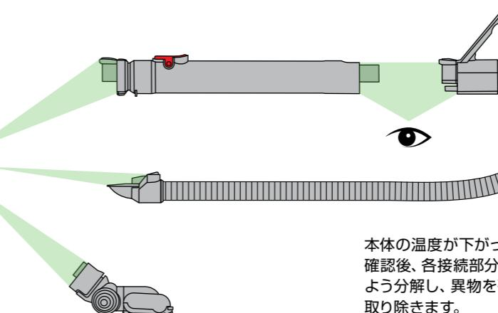
本体の温度が下がったことを確認後、各接続部分が見えるよう分解し、異物を確かめ取り除きます。
