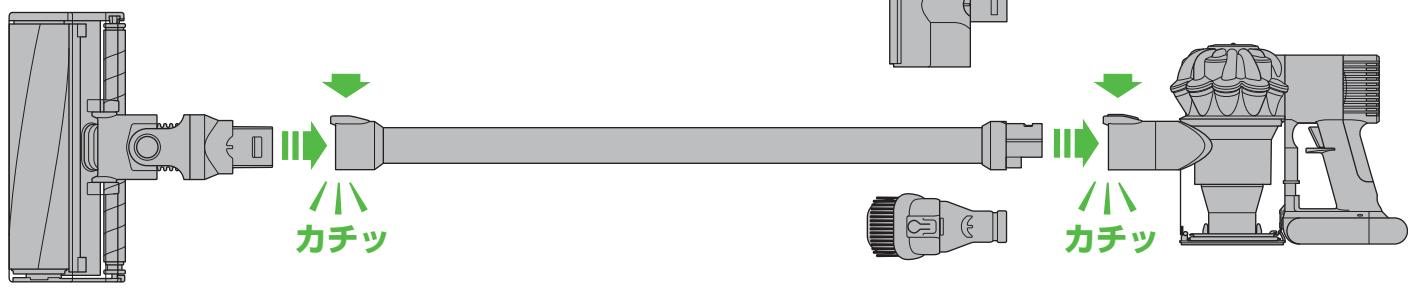
用途に合わせてクリーナーヘッドをパイプの先に装着します。
