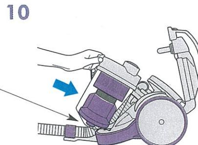
透明シリンダーのフタを戻し、ツメがしっかりと留まるまで押してください。透明シリンダーの底のツメが本体の溝にしっかりと収まるように所定の位置に戻して下さい。
