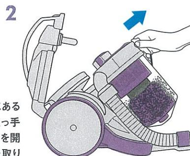
本体の取っ手の先にあるストッパーを押して取っ手を引き上げ、本体フタを開け、透明シリンダーを取り出します。
