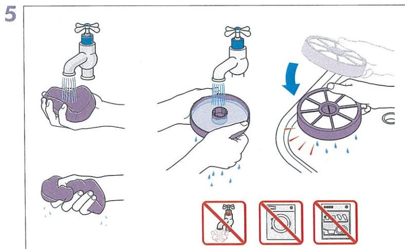
フィルターフレームと泡状パットは、別々に洗浄してください。水道の水を流しなが
