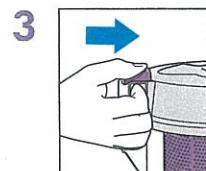
透明シリンダーの取っ手の上にあるツメを押して、取っ手を握りながらシリンダーのフタを取りはずします。
