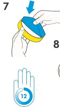
7 フィルターが完全に乾いてから取り付けてください。最低12時間は乾燥させてください。
