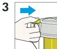
3 透明シリンダーの取っ手の上にあるツメを押して、取っ手を握りながらシリンダーのフタを取りはずします。
