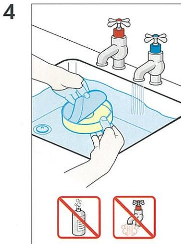
4 取り出したフィルターを水のなかに浸し、泡状パットのつまみ部分を握りながら、パットをフィルターフレームからはがします。その際、洗剤およびお湯は使用しないでください。
