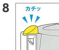
8 カチッ 透明シリンダーのフタを戻し、ツメがしっかり留まるまで押してください。透明シリンダーの底のツメが本体の溝にしっかり収まるように所定の位置に戻して下さい。
